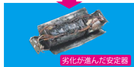
劣化が進んだ安定器
