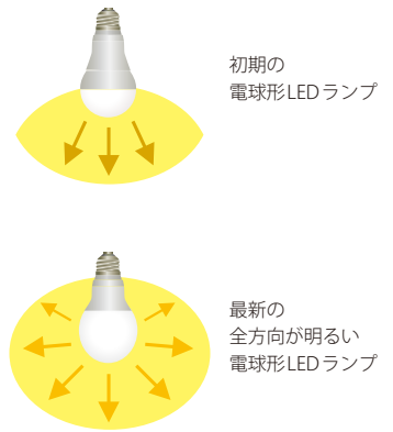
従来に比べて 【電球形LEDランプの光の広がり方のイメージ】
